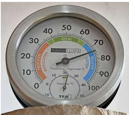
Ein einfaches Hygrometer zeigt an, wenn die Luftfeuchtigkeit im Raum zu hoch ist.
